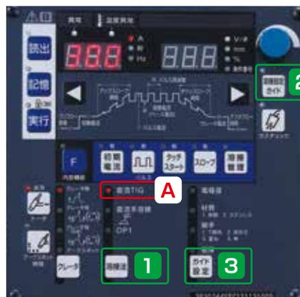
4개의 조건을 설정하는 것만으로, 「용접전류-초기전류-크레이터전류」 등의 조건 맞춤형 용접기가 실행합니다. 이것으로 용접 조건조정이 간단하게 되어, 용접작업의 효율화를 실현합니다.
