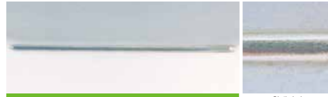
SUS304, 두께 0.3mm 맞대기, 용접조건 : 베이스전류 2A, 펄스전류 10A, 펄스 주파수 999Hz
